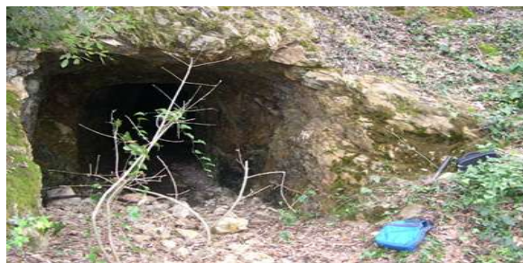
Figura 2: Galleria di saggio della magnesite in località Fortullino
